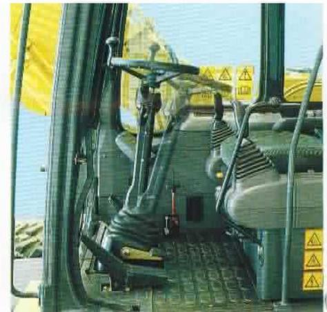
**Lenkung:** Die vollhydraulische Lenkung in Verbindung mit der verstellbaren Lenksäule bietet einen hohen Komfort.
