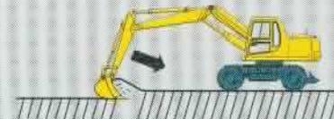
**Löffel** richtig füllen ist leicht, weil bei Simultanbewegungen die Arbeitsausrüstung mit maximaler Kraft besonders präzise bewegt werden kann.
