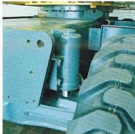
**Stabile Pendelachsbremse.** Die Pendelachsbremse verleiht der Maschine einen sicheren Stand beim Graben. Drei Schaltmöglichkeiten stehen dem Fahrer zur Verfügung: Ein, Aus und Automatik – damit sind kurze Ortswechsel auf der Baustelle schnell und einfach durchgeführt.
