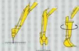
**Ausrüstungswechsel** ist leicht - selbst bei Hydraulikhämmern, Abbruchwerkzeugen usw., die unterschiedliche Ölmenngen brauchen - weil die Ölmenge ganz einfach mit der entsprechenden Betriebsart im Monitor-Bedienfeld gewählt wird.
