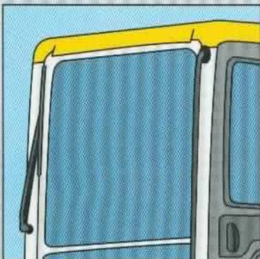
Durch Einbau des **Scheibenwischers** in den Kabinenrahmen konnte die Scheibenfläche für noch bessere Sicht vergrößert werden.
