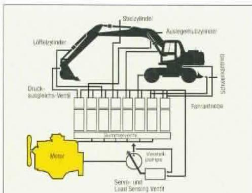
Im HydraMind System regeln Load-Sensing- und Druckausgleichsventile automatisch die lastunabhängige Druckölverteilung. Das System ist einfach und auch deshalb so außergewöhnlich zuverlässig.
