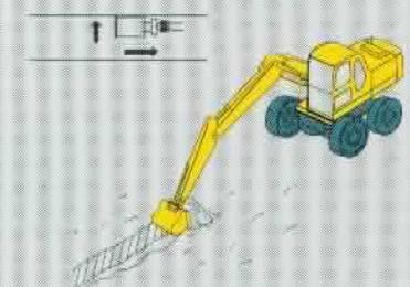
**Graben** entlang senkrechter Wände ist leicht, weil das System eine kraftvolle Seitenführung mit hohen Schnittkräften vom Schwenkreis her bereithält.
