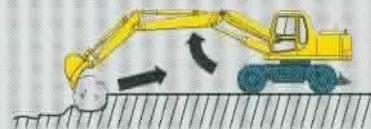
**Graben** im weichen Fels oder Herausziehen von Kräppern ist leicht, weil das System sehr genau das Auslegerheben kontrolliert und ein Herausrutschen der Löffelschneide verhindert.
